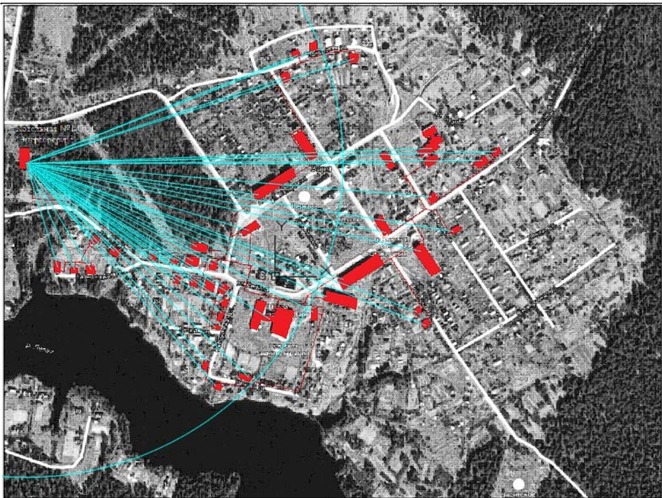
Рисунок 2.4.1 – Радиус эффективного теплоснабжения котельной ООО «Энергоресурс».
